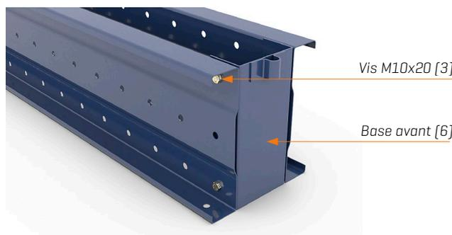
De même, ces vis ne doivent pas être complètement serrées afin de permettre la mobilité nécessaire pour niveler les bases ultérieurement, tel qu'indiqué dans l'étape 5.
