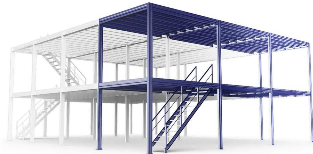
La conception du système garantit que la structure se comporte avec une stabilité absolue. L'étage surélevé offre une base adéquate pour diverses utilisations, dans ses correspondantes plages de tolérances des efforts. Grâce aux méthodes de soudure et de fixation employées, on obtient des unions très solides, dotant la structure de la rigidité nécessaire pour les conditions de service auxquelles elle va être soumise.
