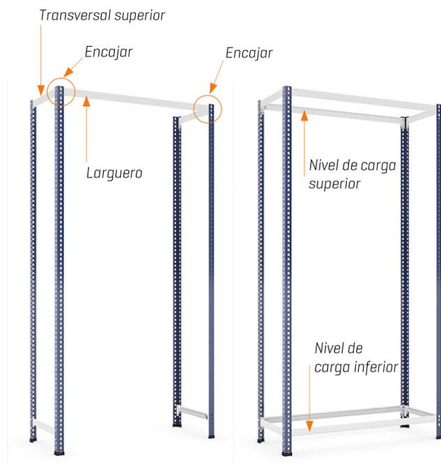
Colocar de pie ambos bastidores y encajar los extremos izquierdo y derecho de uno de los largueros a los perfiles respectivos de cada bastidor y a la altura de los transversales superiores montadas previamente. El sistema de encaje es el mismo anteriormente descrito.
