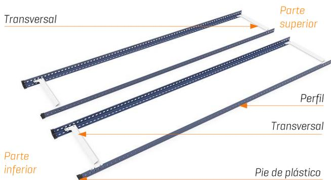
Encastrar las transversales superiores e inferiores en cada par de perfiles para conformar los dos bastidores.
