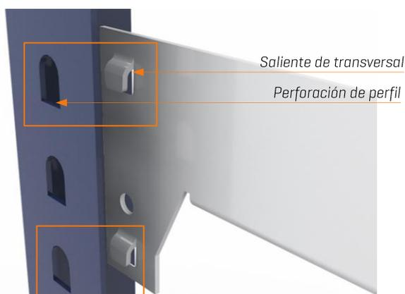
La unión debe hacerse introduciendo los salientes de la transversal en las perforaciones del perfil, por la cara interna de este, de forma que dichos salientes queden a la vista por la cara externa del mismo.
