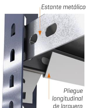
Estantes metálicos galvanizados o pintados: posicionar el estante metálico de forma que sus bordes encajen en el interior de los pliegues longitudinales de los largueros.
