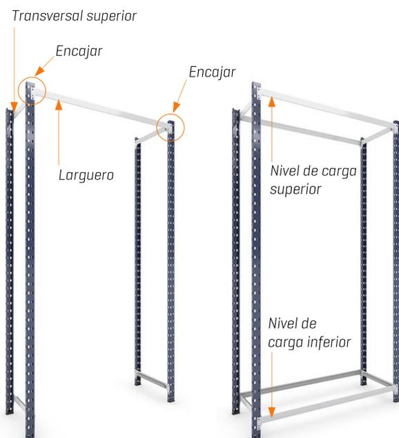
Colocar de pie ambos bastidores y encajar los extremos izquierdo y derecho de uno de los largueros a los perfiles respectivos de cada bastidor y a la altura de los transversales superiores montadas previamente. El sistema de encastre es el mismo anteriormente descrito.
