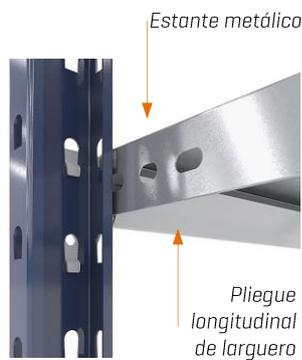
Estantes metálicos galvanizados o pintados: posicionar el estante metálico de forma que sus bordes encajen en el interior de los pliegues longitudinales de los largueros.
