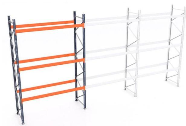
A continuación colocar el resto de largueros [7] hasta completar todos los niveles, finalizando así el montaje del módulo inicial.
