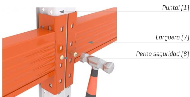
Una vez correctamente encastrados, se fijarán mediante pernos de seguridad [8]. Estos se insertan en sus alojamientos con la ayuda de unos pequeños golpes hasta su introducción completa.
