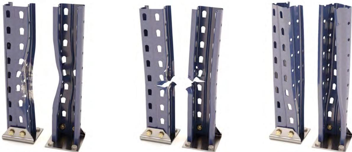
Puntales dañados por abolladura, desgarró y torsión
