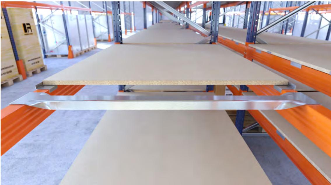
Asimismo, en los niveles de picking sobre larguero de tubo, deben incluirse además topes retenedores para el tablero, con el fin de evitar posibles desplazamientos de la superficie debido al rozamiento durante la manipulación de las mercancías.
