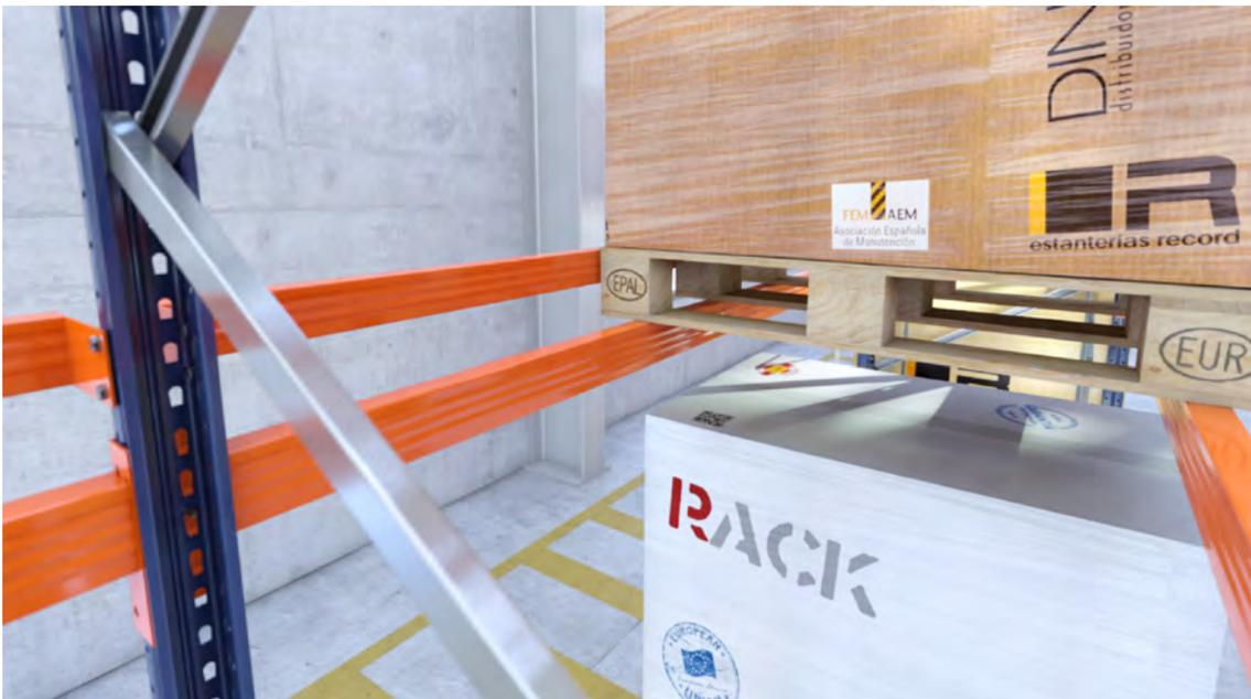
Son de utilidad para servir de referencia en la parte posterior del nivel de carga, facilitando la maniobra de posicionamiento de la paleta y para que esta (no la carga) esté en contacto constante con este elemento de seguridad; de esta forma se evita un mal posicionamiento de la carga, previniendo posibles caídas de las mercancías almacenadas.
