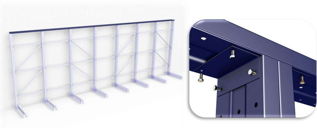
**Esquema arriostramiento superior y detalle de fijación mediante tornillos 10x20**
