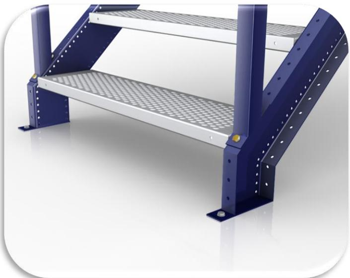
La escalera desmontable se compone de dos zancas, fabricadas con perfiles en U, de acero laminado en frío, donde se atornillan los peldaños y la baranda. En los puntales de baranda se introduce la protección de 20 mm de diámetro y se apoya en su parte superior el pasamanos. Dicho sistema consta de los elementos de terminación adecuados.
