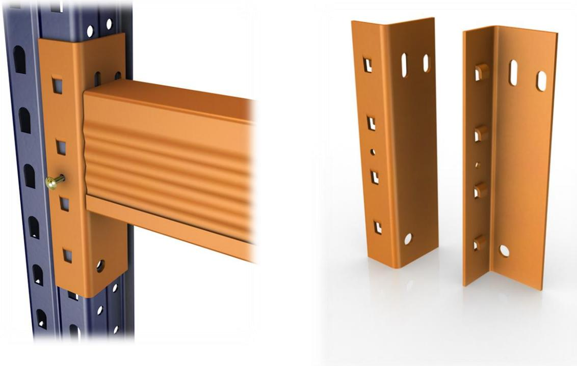
La fijación al bastidor se realiza con cuatro salientes de 11 mm cada uno, efectuados en el conector que se encastran en los huecos correspondientes del bastidor. Este tipo de unión está específicamente diseñada para transmitir correctamente los empujes de la carga de servicio minimizando los esfuerzos del sistema, autocentrando las compresiones para evitar los riesgos de tensiones de cortadura.
